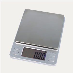
Digitale Feinwaage 0,01 g - 1000 g, 1 St.
